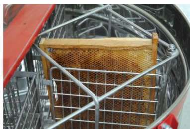
Obr. 2 – správne uloženie rámkov v kazetovom medomete
