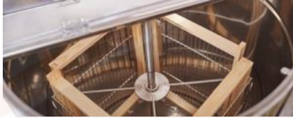
Obr. 1: správne uloženie rámkov v radiálnom medomete
