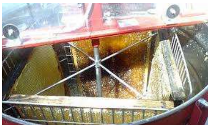
1.-es ábra Keret elhelyezése tangenciális mézpergetőbe
