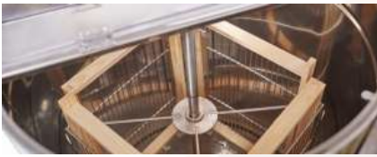
1.-ábra: helyes keret elhelyezése a sugaras mézpergetőben
