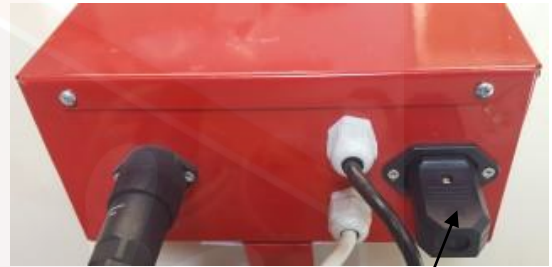
Obr. a2 - EURO konektor M zapojený namiesto bezpečnostného zámku krytu
