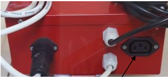
Obr. a1 – EURO konektor F pre pripojenie bezpečnostného zámku krytu
