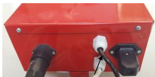
Obr. a2 - EURO konektor M zapojený namiesto bezpečnostného zámku krytu
