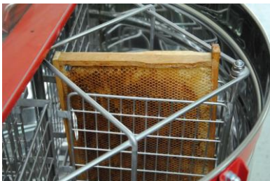
Obr. 1 – správne uloženie rámkov v kazetovom medomete
