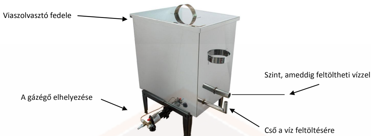
9.-es ábra: Viaszolvasztó – előkészületek a használatára
