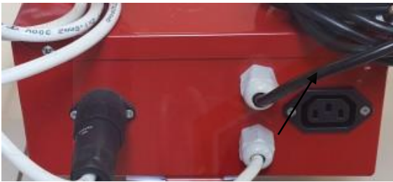
1.-es a ábra – F EURO konnektor a fedél szolgáló biztonsági zár csatlakoztatására
