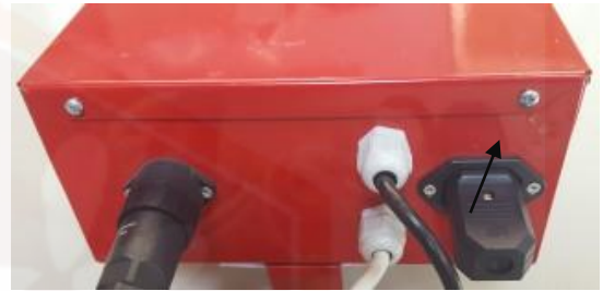
2.-es a ábra - M EURO konnektor a fedél kinyitására szolgáló biztonsági zár helyett
