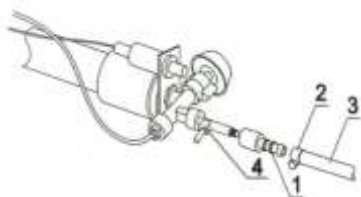
Obr.2: Pripojenie plynovej hadice k horáku
